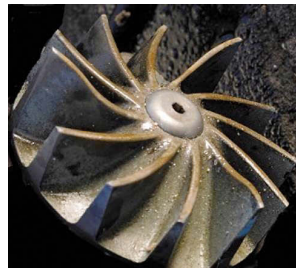
Abb. 4: Neue Laufradgeneration in GG20 (ein Gusseisen mit Lamellengraphit) für faserhaltige Abwässer
