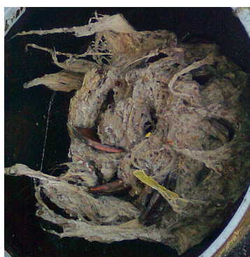
Abb. 1: Verstopfung der Kreiselkammer
